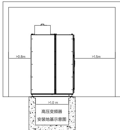
※ 所有柜体应固定安装于槽钢底座之上, 并和厂房大地可靠连接, 高压进线电缆与出线电缆的防护铠甲应可靠接地, 并与柜体可靠固定, 具有足够的机械强度, 并保持高压技术规范中规定的对地绝缘距离。
