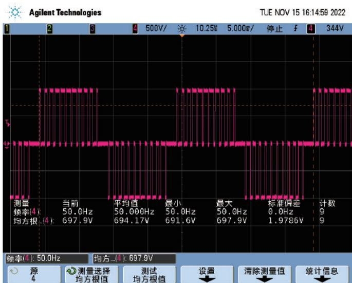
图2-6 功率单元输出波形实测图
