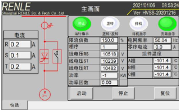
图 5-5 软启动器待机面板图
