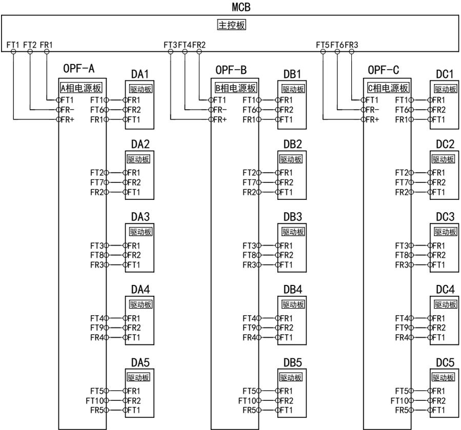
图 2-7 光纤连接图
