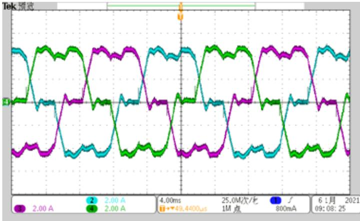
图 5-4 电机电流示波器波形
