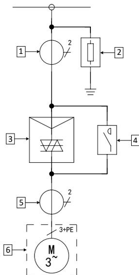
图 2-1 智能高压固态软起动柜系统图
