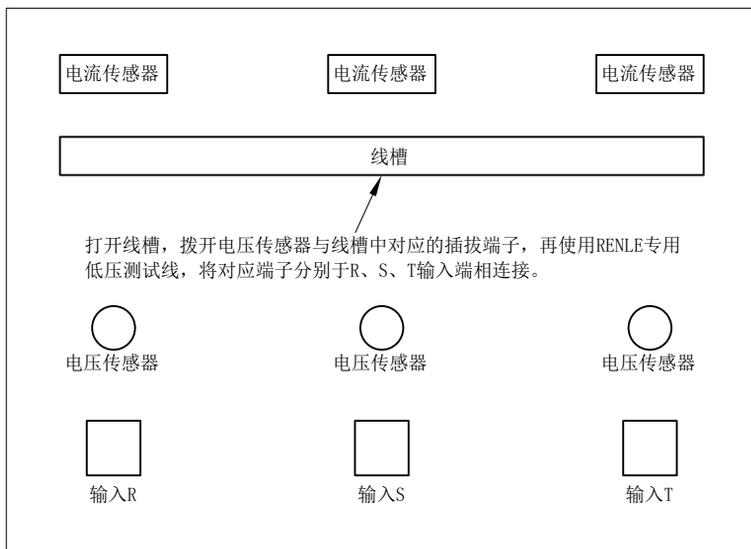
图 5-3 RENLE 专用低压测试线连接图
